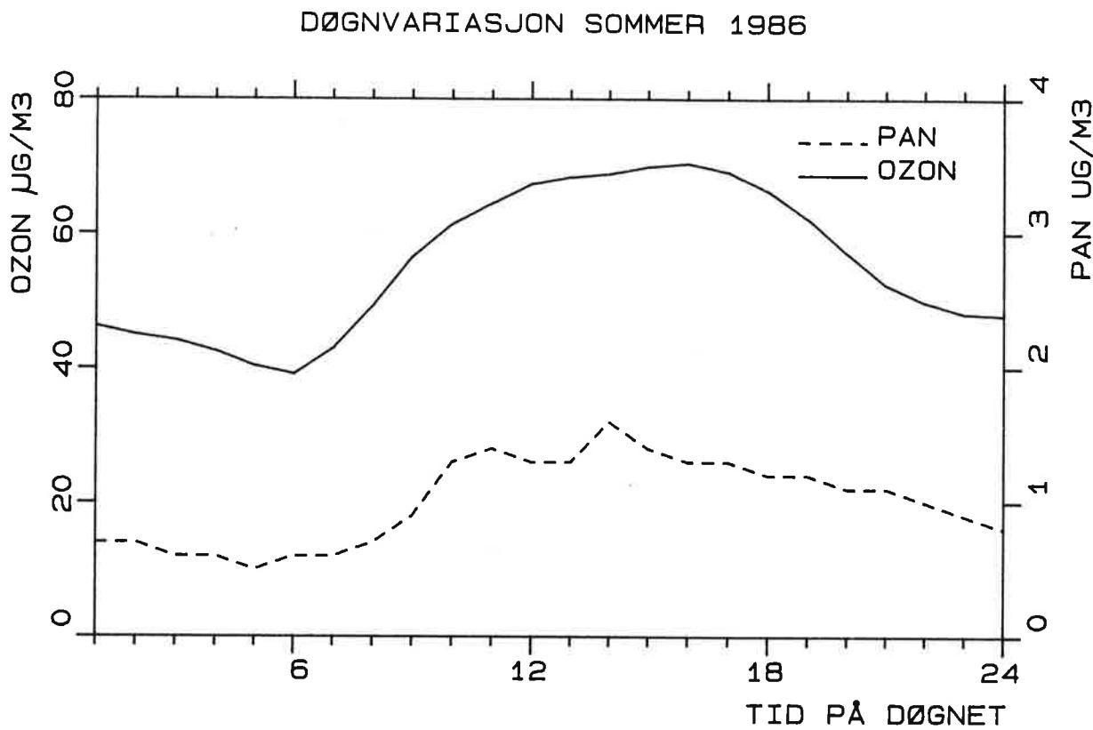
Figur 4: Døgnfordeling av midlere timesvise konsentrasjoner av ozon og PAN ( $\mu\text{g}/\text{m}^3$ ) på Klyve i 1986.
