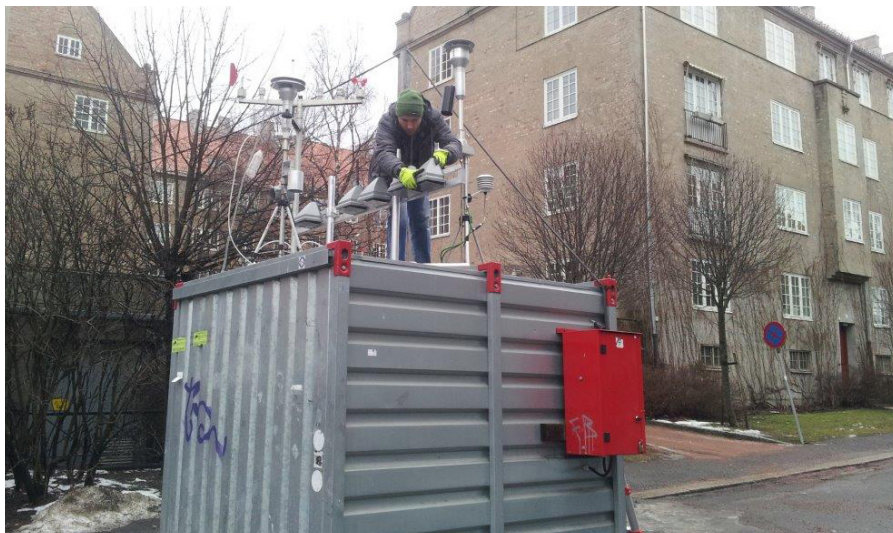
Forskere fra NILU og Technion Israel Institute of Technology evaluerte i 2015 24 lavkost-sensorer av typen AQMesh (under). Disse sensorene ble montert oppå den veinære målestasjonen i Kirkeveien (over), så forskerne kunne sammenlikne målinger fra den med AQMesh-sensorenes målinger av luftkvaliteten samme sted.
