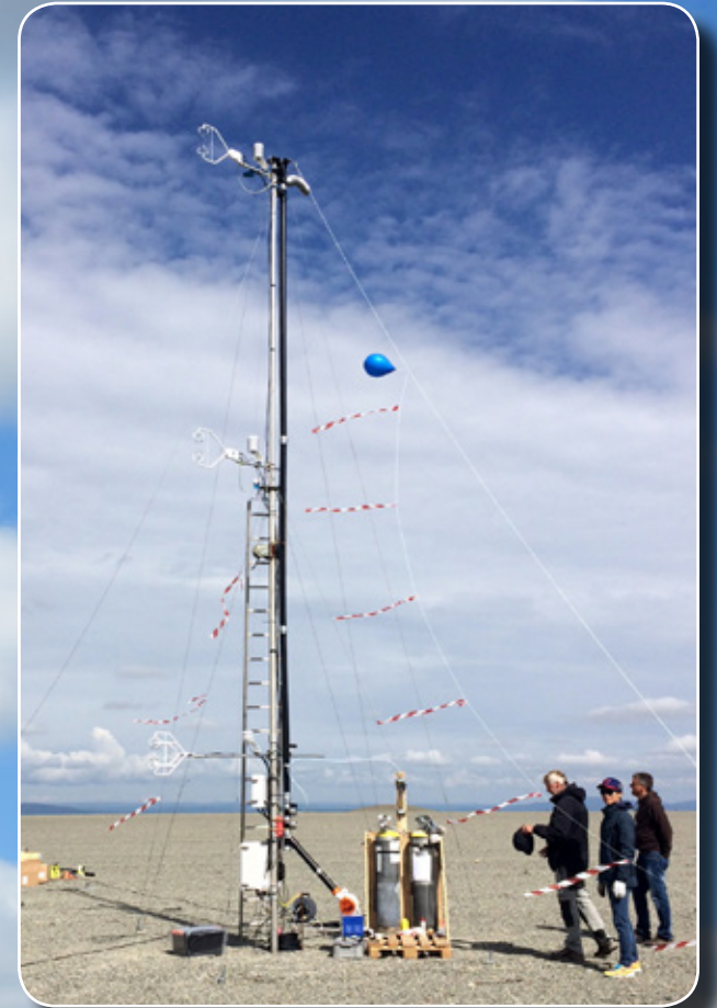
6 UV-kameraer ble plassert like ved, for en følsomhetsstudie i 2D der mengden SO 2 som ble sluppet ut varierte trinnvis. På tårnet er det tre sett med måleinstrumenter for å måle turbulens, og SO 2 blandet med luft slippes ut gjennom det svarte røret og dysen ses på toppen av masten.
