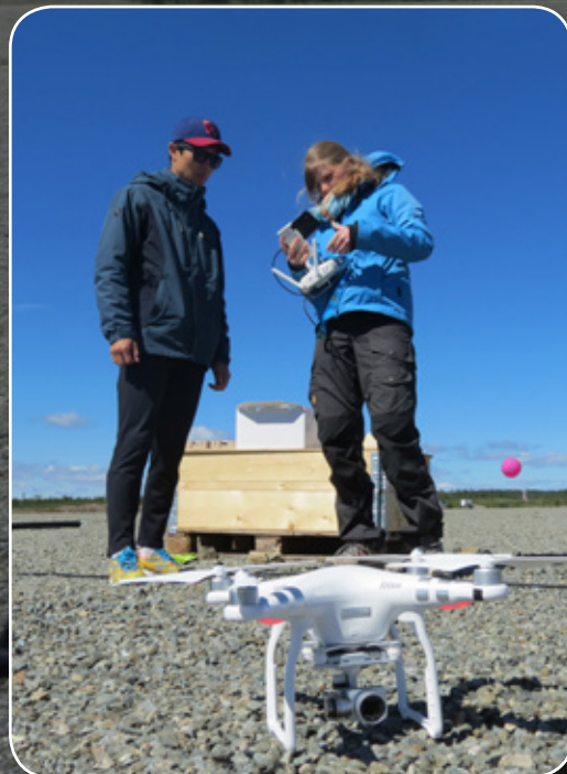
Massimo Cassiani og Norbert Schmidbauer legger til flere merker på SO 2 -gassflytmåleren i forbindelse med en følsomhetstest: NILU øker andelen SO 2 som slippes ut og sammenlikner det med SO 2 -fluksene som måles med kameraene.
